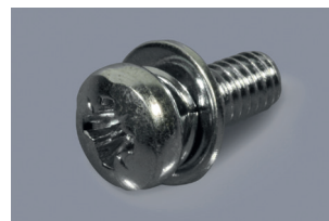
DIN 6900-3 Z4-1 Z Linsenkopfschraube Pozi mit Federring und flacher U-Scheibe
